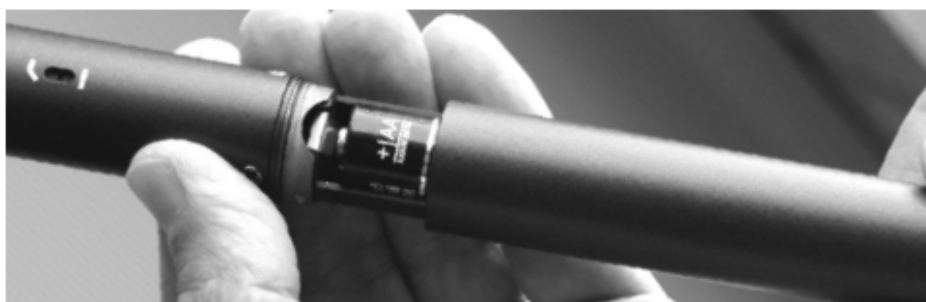
Slika 3. Zatvaranje pretinca za baterije
