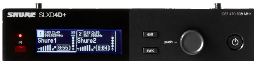
Slika 1. Prednja strana mikrofonskog prijemnika Shure SLXD4D
