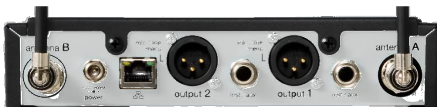
Slika 2. Stražnja strana mikrofonskog prijemnika Shure SLXD4D
