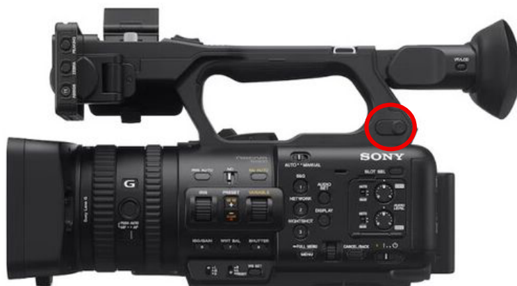
Slika 21. Prikaz priključka za slušalice na kameri Sony HXR-NX800
