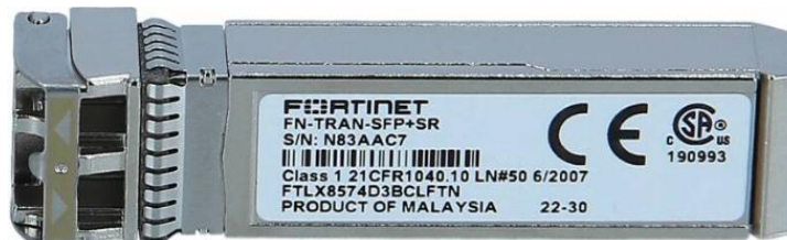
Slika 28. Višemodni optički modul FN-TRAN-SFP+SR
