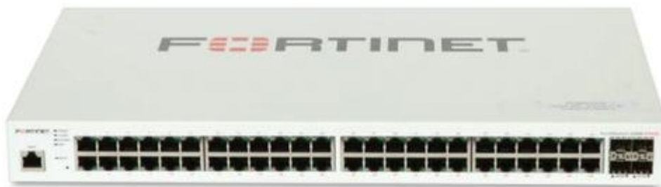
Slika 23. Preklopnik FortiSwitch FS-148F-FPOE
