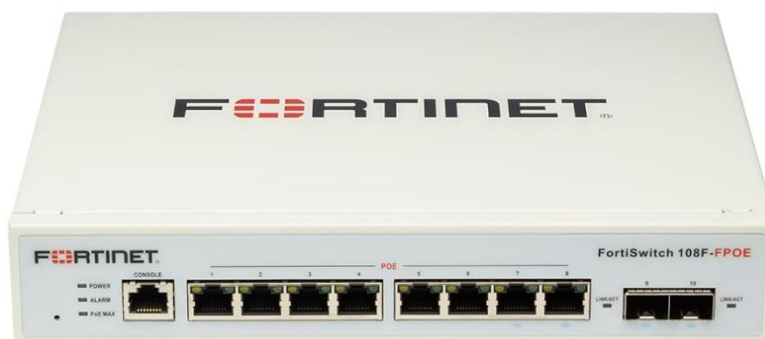
Slika 21. Preklopnik FortiSwitch FS-108F-FPoE
